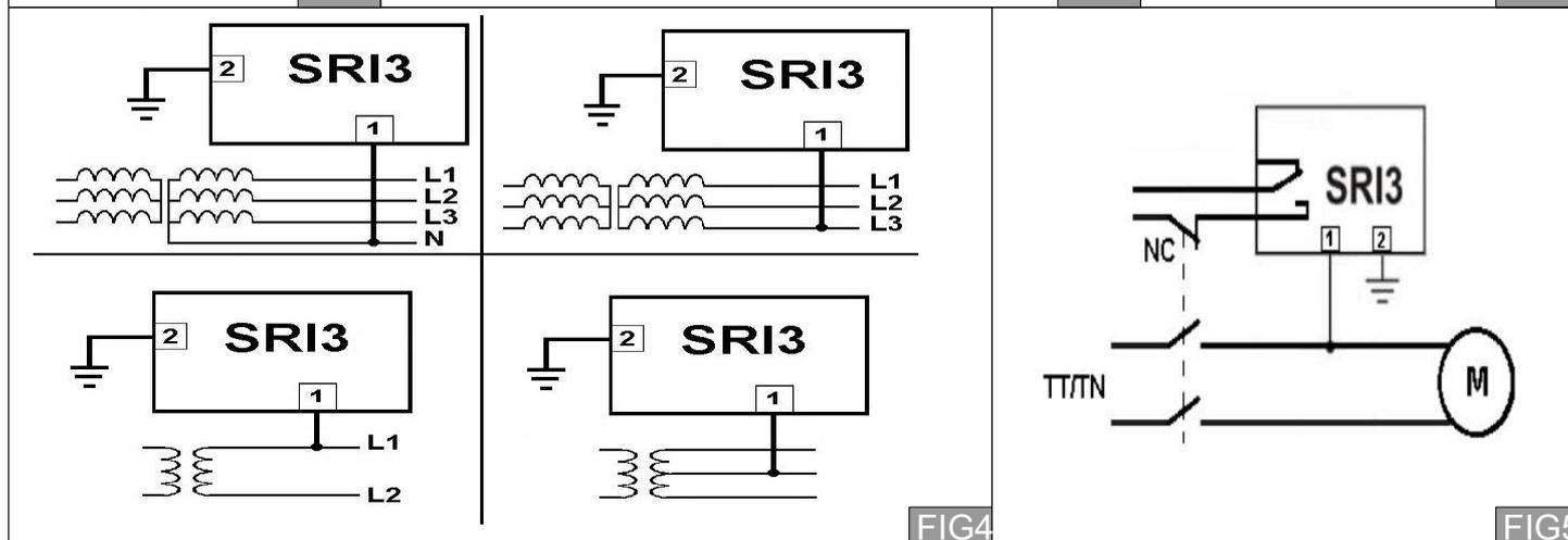
**ATTENZIONE:** Gli IMD non devono essere collegati in parallelo- **WARNING:** IMDs shall not be connected in parallel
